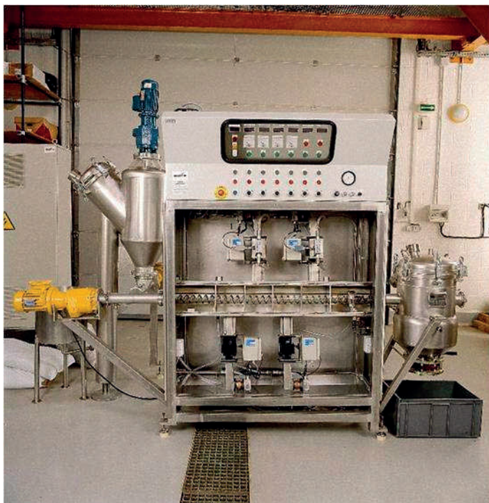
Figure 73 : Prototype du dispositif d'extraction par micro-onde en continu pour la fabrication des jus de fruits
